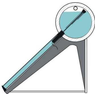
Az érzékelő az alsó gyűjtőcső furatára szerelve
